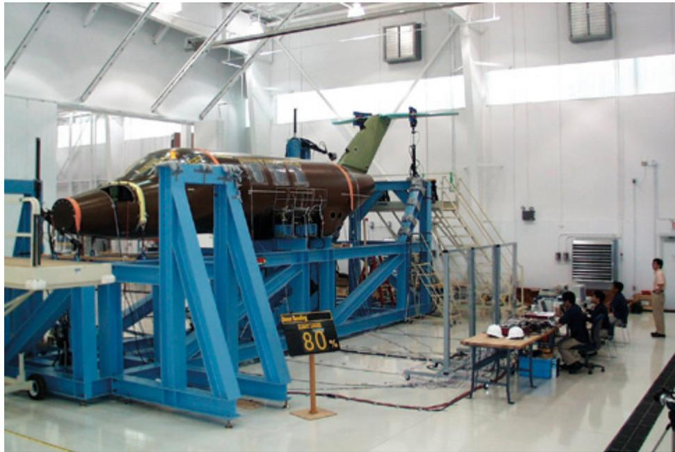
◀ TEST DE MATERIALES PARA EL FUSELAJE DE LOS PROTOTIPOS DEL HONDAJET.
