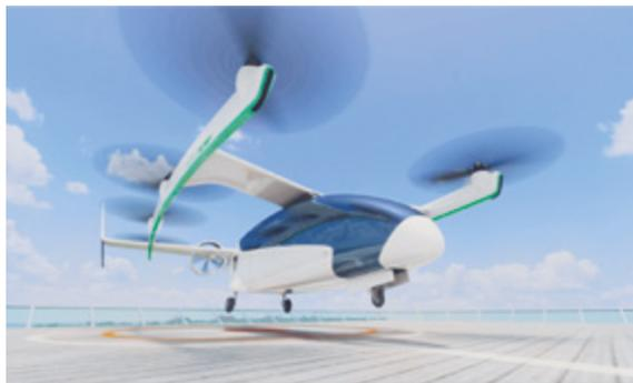
Las ocho hélices y los dos propulsores del *Honda eVTOL* funcionan con energía eléctrica generada por una turbina de gas. Esta configuración permite una autonomía superior. Aunque no pueda igualar en alcance a los aviones comerciales, se estima que el eVTOL podrá recorrer hasta 400 km de distancia.
